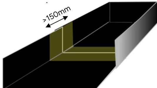
3. Adhiera Effisus Bond FT, centrándolo con la junta, retirando progresivamente la lámina protectora y presionando la cinta con un rodillo de silicona. Aplique la cinta Effisus Bond FT con una anchura mínima de 150 mm, con un mínimo de 75 mm para cada lado de la junta de solapamiento de la membrana.
