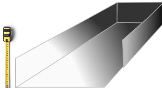
2. Aplique Effisus Primer 9800 en toda la superficie del canalón con un rodillo o una brocha. Deje secar la imprimación antes de adherir la membrana Effisus Alltitegutter.
