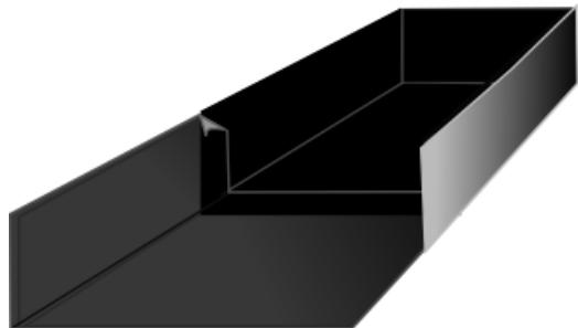
2. Aplique una capa de Effisus Primer RED+ con un ancho mínimo de 150 mm, centrada con la junta. Deje secar la imprimación antes de pegar la cinta para juntas superpuesta.
