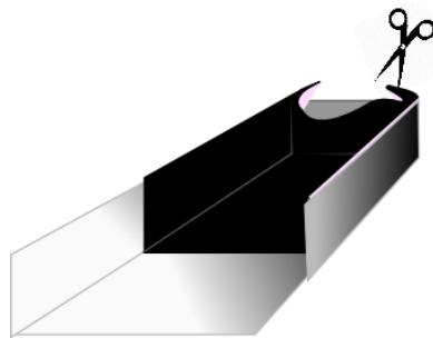
2. Retire la lámina protectora y adhiera la membrana al canalón en la posición deseada. Presione con un rodillo de silicona para facilitar la adherencia de la membrana.
