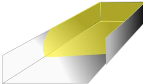
3. Corte la membrana Effisus Alltitegutter con las dimensiones requeridas. Corte la lámina protectora de acuerdo con las dimensiones y áreas del canalón, tal y como se muestra en la imagen lateral (parte inferior, laterales, etc.). Asegúrese de cortar la membrana por debajo de la lámina protectora.
