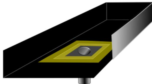
2. Coloque la cinta Effisus Bond FT sobre la zona imprimada alrededor del perímetro de la salida del desagüe. Aplique la cinta Bond FT con dos bandas, tal y como se muestra en las dos imágenes de la derecha, tal y como se indica en (1) y (2), con un solapamiento mínimo de 75 mm. Presione y moldee la cinta Effisus Bond FT con la mano. Pase el rodillo de silicona de 50 mm de ancho por el tapajuntas. El solapamiento de la cinta sobre la membrana Effisus Alltitegutter debe ser de un mínimo de 75 mm.
