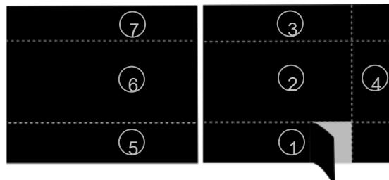
4. Adhiera la membrana Effisus Alltitegutter al canalón, en la posición final prevista. Pásese un rodillo de silicona para mejorar la adhesión y asegurarse de que toda la superficie de la membrana quede adherida a la superficie del canalón.
