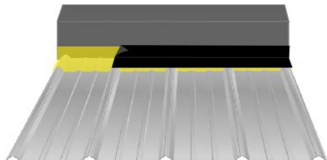
3. Com a mão ou com a ajuda de um rolo de silicone, comece a moldar/ajustar a fita à superfície ondulada. Certifique-se de não esticar demasiado a fita num único ponto (por exemplo, cantos), para evitar qualquer risco de danificá-la.
