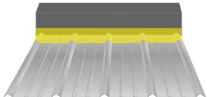
2. Comece a colar a fita ao substrato retirando progressivamente a película protetora e colando a fita de forma plana, sem forçá-la a seguir a superfície ondulada.
