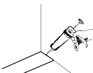
Sele as bordas da fita Effisus Bond FT com uma camada de 5 mm de diâmetro do selante adesivo Effisus Bonding KF+P.
