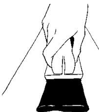
Aplique o Effisus Primer RED+ em todas as superfícies onde a Effisus Bond FT será aplicada, utilizando a esponja fornecida. Esfregue bem a membrana enquanto o primário estiver molhado, movendo-se para cima e para baixo na área da junta. Deixe o primário secar ao toque (sem transferência de material). O tempo de secagem varia dependendo da temperatura ambiente e da umidade (normalmente menos de 20 minutos).
