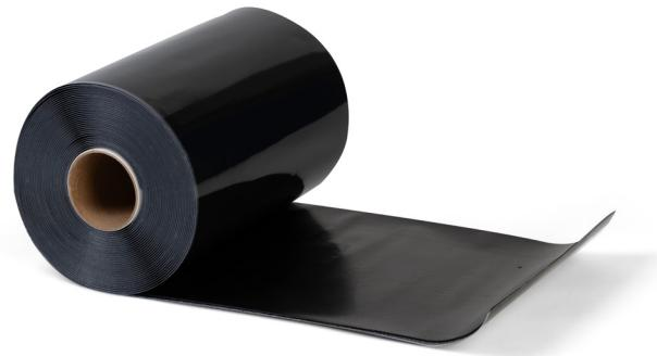
La Cinta Effisus Bond FT consiste en una membrana EPDM no curada, laminada a una capa adhesiva que se activa por presión, de espesor 0,64 mm, integrando una tecnología probada. La cinta Effisus Bond FT es extremadamente flexible, maleable y puede adaptarse a formas y superficies irregulares. Una vez curada, la cinta es muy resistente a la humedad, los rayos UV, las variaciones de temperatura y los movimientos estructurales.
